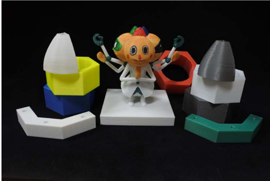
図 2 提案手法により情報を埋め込んだ熱溶解積層(FDM)方式の造形物
