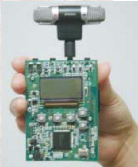
音源分離装置(BSS)は携帯電話、ロボット対話などへの応用が検討されている。
