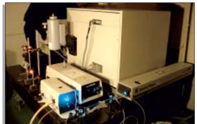
タンパク質の金属部位構造を調べる共鳴ラマン装置
