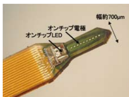
生体脳計測用光・電気マルチファンクショナルイメージセンサ
